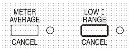
Um die Messschwankungen bei veränderlichen Lasten zu reduzieren, kann durch Drücken auf die Taste METER AVERAGE eine Zeitkonstante von 2 Sekunden gewählt werden – ist diese Funktion aktiviert, so leuchtet eine Anzeige neben der Taste auf. Drücken Sie die Taste erneut, um diese Mittelung zu annullieren und zur Standardzeitkonstante von 20 ms zurückzukehren.
