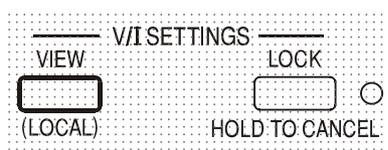
Die eingestellten Spannungs- und Strombegrenzungswerte werden immer angezeigt, wenn der Ausgang abgeschaltet ist, können aber auch bei eingeschaltetem Ausgang eingesehen werden, wenn Sie die Taste VIEW drücken – die SETTINGS Anzeige leuchtet auf, während die VIEW Taste gedrückt ist.
