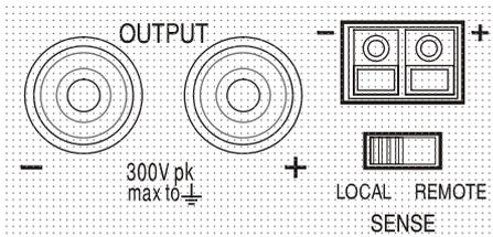
Dieses Problem lässt sich zwar durch Verwendung kurzer Anschlusskabel mit großem Querschnitt einschränken, es ist aber besser, diesen Effekt mit Hilfe der Fernfühlerfunktion ganz zu umgehen. Dazu müssen die Fernfühlerklemmen (Sense) an der Last anstelle der Spannungsquelle angeschlossen werden. Schließen Sie die Kabel an die Federklemmen des SENSE-Anschlusses und direkt an der Last an. Setzen Sie den Schalter LOCAL/REMOTE auf REMOTE.
