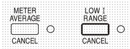
Der obere Grenzwert für den CURRENT Regler kann durch abwechselndes Drücken der LOW I RANGE Taste zwischen dem Maximalwert für dieses Gerät und 75mA umgeschaltet werden, um so eine Feineinstellung der Strombegrenzung und der Messauflösung (0,01mA bis zu 75 mA) zu erreichen.
