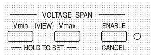
V-Span wird mit der Taste ENABLE aktiviert. Die ENABLE Lampe leuchtet auf, wenn V-Span gewählt ist. Der voreingestellte Wert ist  $V_{\min} = 3V$ ,  $V_{\max} = 5V$
