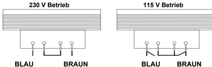
4. Die Wiedermontage erfolgt in umgekehrter Reihenfolge zum Ausbau. Um den Sicherheitsvorschriften zu entsprechen, muss die auf der Rückwand angegebene Betriebsspannung so geändert werden, dass die neue Einstellung der Betriebsspannung deutlich zu erkennen ist.
